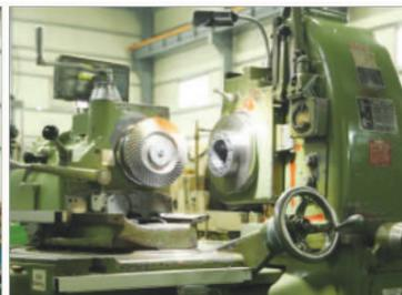
■ Bevel Gear Tester(Ø10~Ø350)
