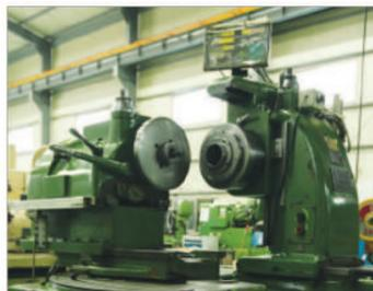
■ Bevel Gear Tester(Ø150~Ø800)
